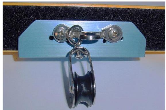
Süllrand-Halter beim reduzierten Luftschlauch (weniger Luft) den Deckstoff etwas herunter drücken und den Süllrand-Halter unter den Holz-Süllrand >schräg unter den Süllrand haken> und gerade ausrichten.
